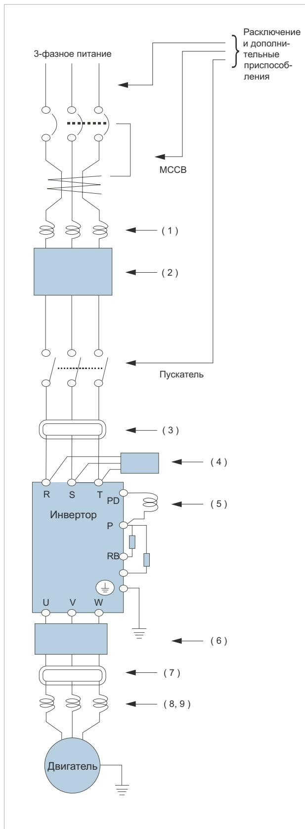
Чувствительность автоматического выключателя в литом к корпусе (MCCB) к утечкам тока зависит от суммарной длины проводов между частотным преобразователем и источником его питания и между частотным преобразователем и электродвигателем.
